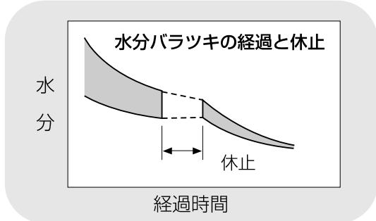
複数の田(畑)の糲(麦)を張込む、倒伏した糲など水分バラツキが多い場合に使用します。
