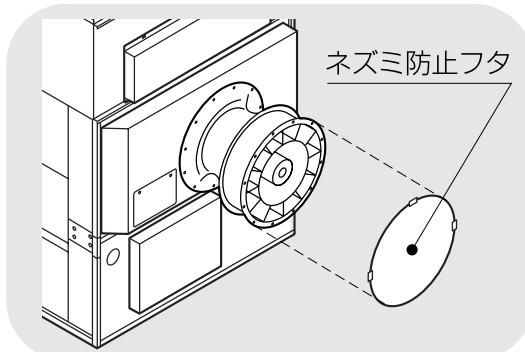
① 排風ダクトを取りはずし、ネズミにかじられないように保管します。ダクト内部のほこりを取り除いて下さい。
