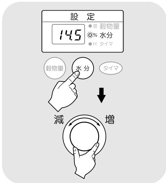
⑥ 設定ツマミを回して、設定表示を目標の『水分値』にセットします。
