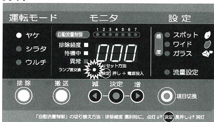
図 5-14 「ランプ要交換」の点灯
