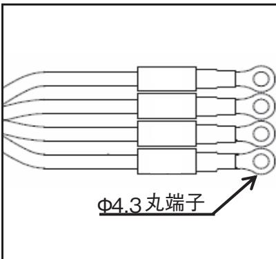
電源コードにP10の仕様を満たした電源プラグを確実にネジ止めしてください。この際、アース線は必ず接続してください。
