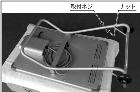
取り付けたハンドルに、スタンドを差し込み、付属のネジとナットで確実に取り付けてください。
