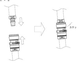
ソケットとプラグを真っ直ぐカチッと音が するまで押し込みます。ロックリングを回し て不用意に抜けないようにロックしてください。
